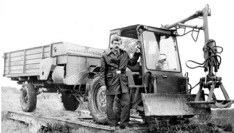
Рисунок 1 – Самоходная машина для раздачи кормов
