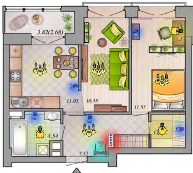
Рисунок 1 – Вариант расстановки элементов системы «HomeMODE» для однокомнатной квартиры
