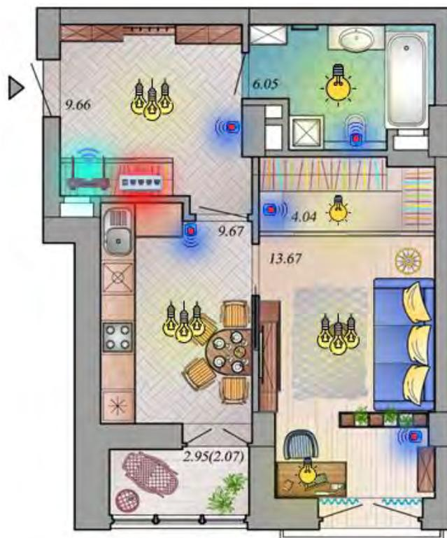
Рисунок 2 – Вариант расстановки элементов системы «HomeMODE» для двухкомнатной квартиры
