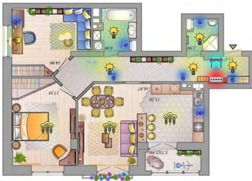
Рисунок 3 – Вариант расстановки элементов системы «HomeMODE» для трехкомнатной квартиры
