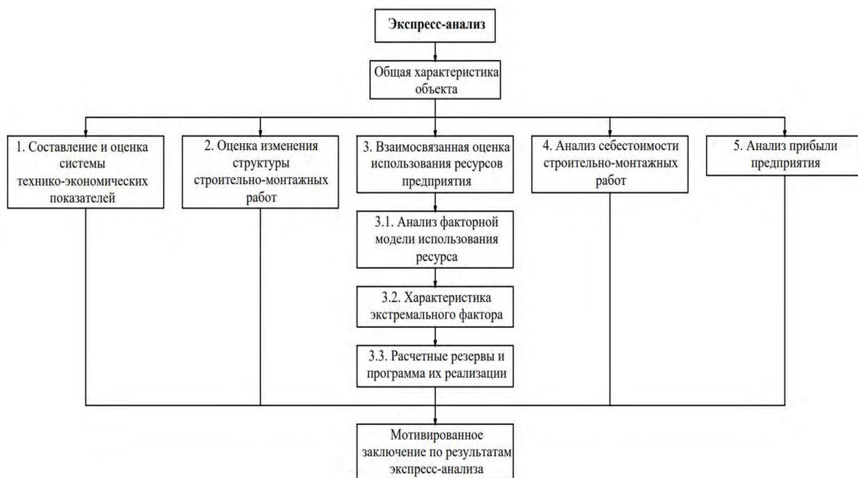
Рисунок 1 – Блок-схема экспресс-анализа производственно-экономического состояния строительной организации
