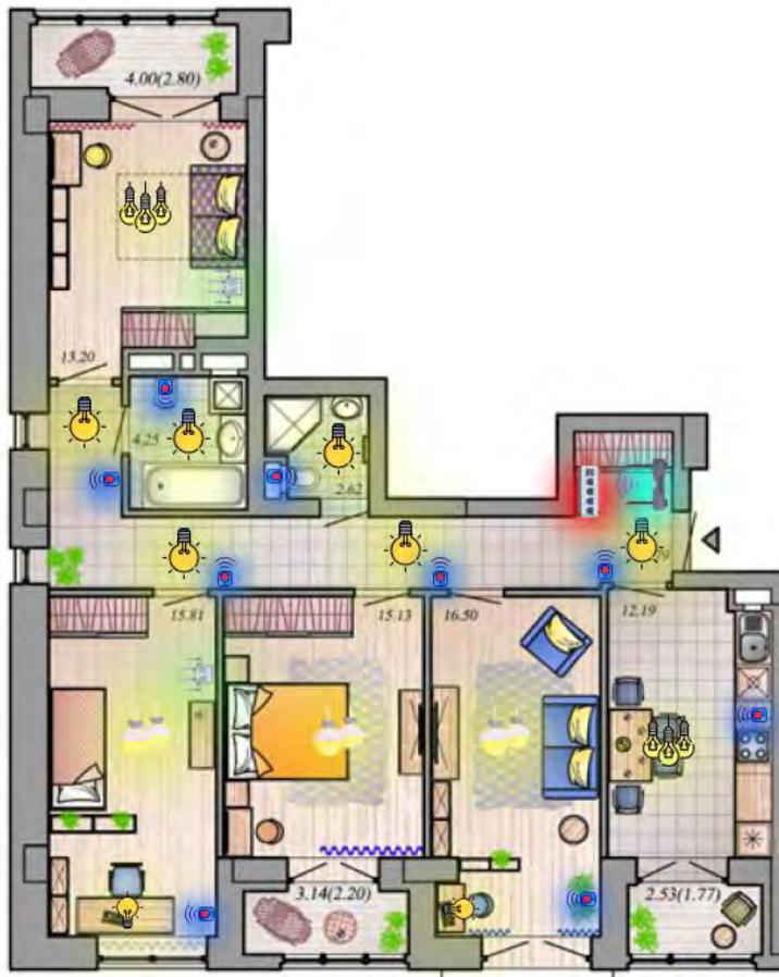
Рисунок 4 – Вариант расстановки элементов системы «HomeMODE» для четырехкомнатной квартиры
