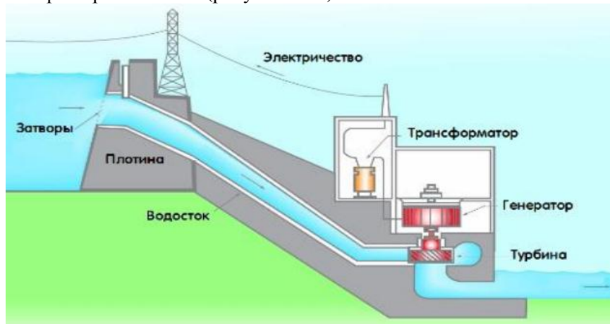
Рисунок 1.41 – Схема работы ГЭС
