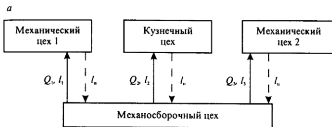
Рисунок 1.22 – Схема веерного маршрута из нескольких пунктов в один
