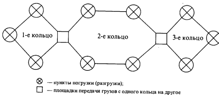
Рисунок 1.27 – Схема циклового маршрута
