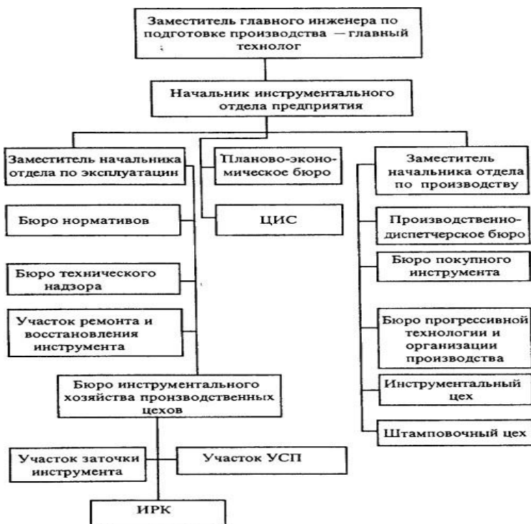
Рисунок 1.18 – Типовая структура управления инструментальным хозяйством машиностроительного предприятия
