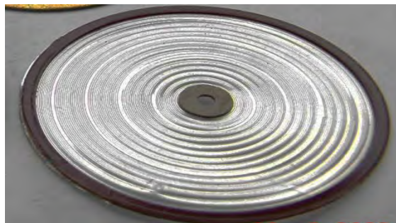
Рис. 2.10. Внешний вид гофрированной майларовой мембраны в ортодинамическом громкоговорителе [17]
