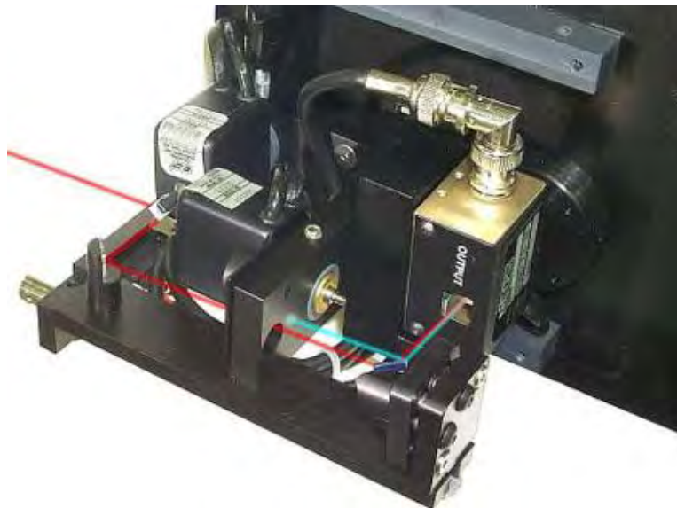
Рис. 8. Излучающая головка лазерного проектора
