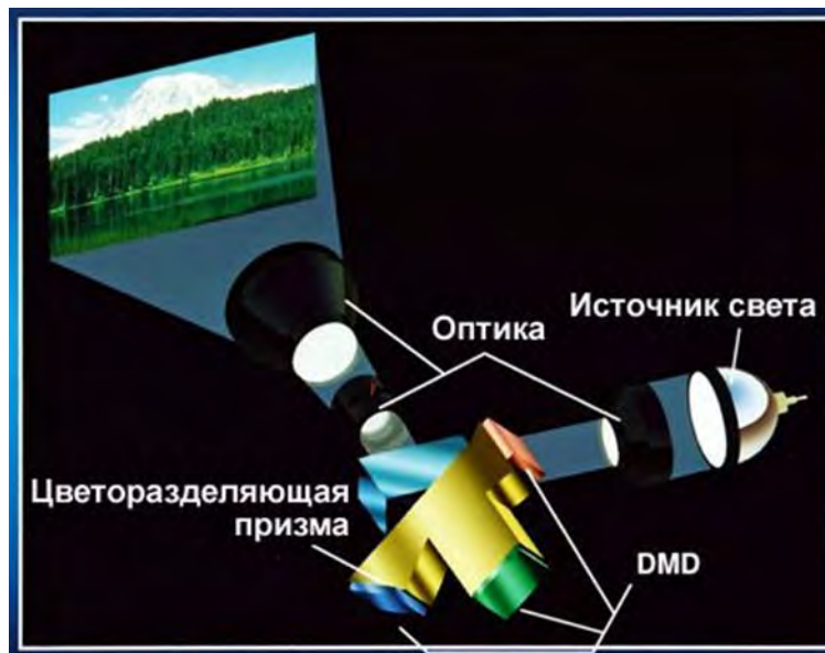
Рис.7. Устройство трех-матричного DLP - видеопроектора
