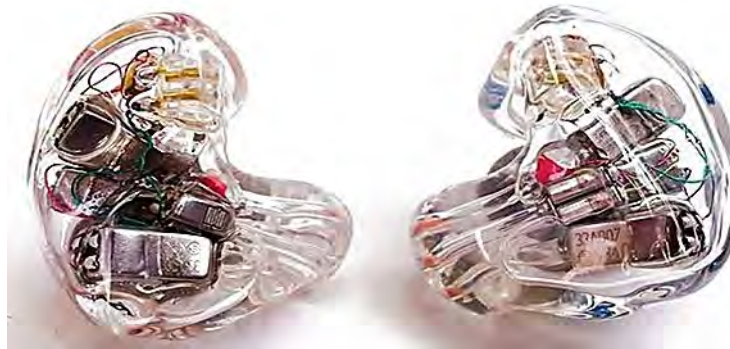
Рис. 3.3.Стереотелефоны Custom с 8-ю излучателями [29]
