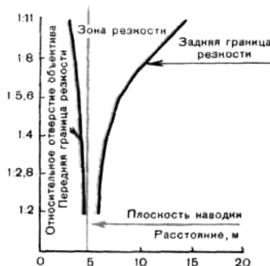
Рис. 1.6. Зависимость зоны резко изображаемого пространства от относительного отверстия объектива (фокусное расстояние 50 м, дистанция наводки 5 м)
