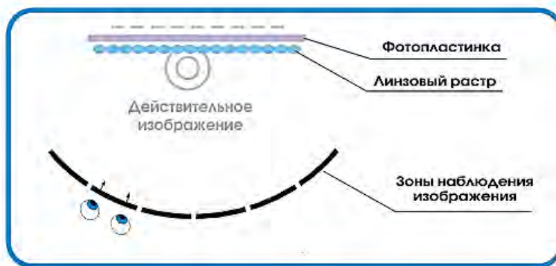
Рис.1. Принцип интегральной фотографии
