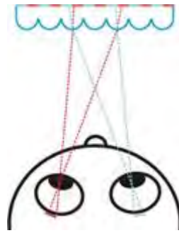
Рис. 6. Схема разделения кодированного изображения стереопары с помощью линзового растра
