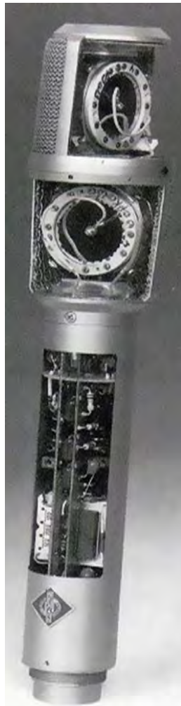
Рис.1.29.Совмещенные микрофоны в системе XY [6]
