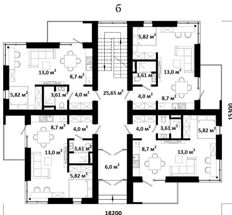
Рис.2.7. Фасад и план односекционного малоэтажного дома
