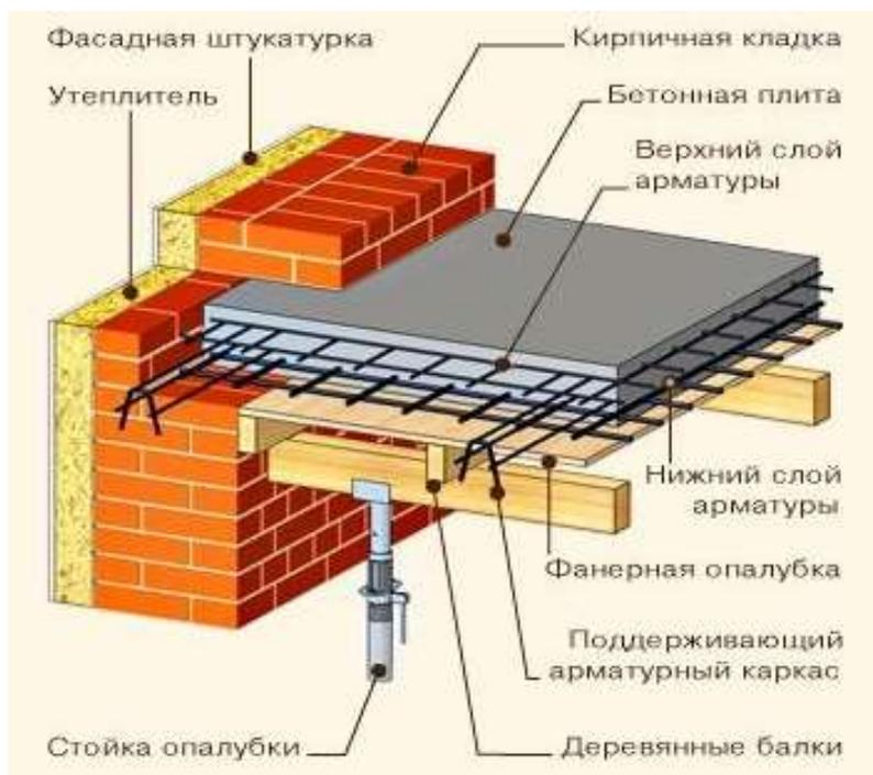
Рис.6.18. Монолитное железобетонное перекрытие.
