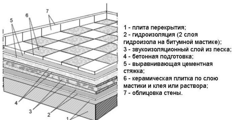
Рис.6.32. Устройство пола в санузле
