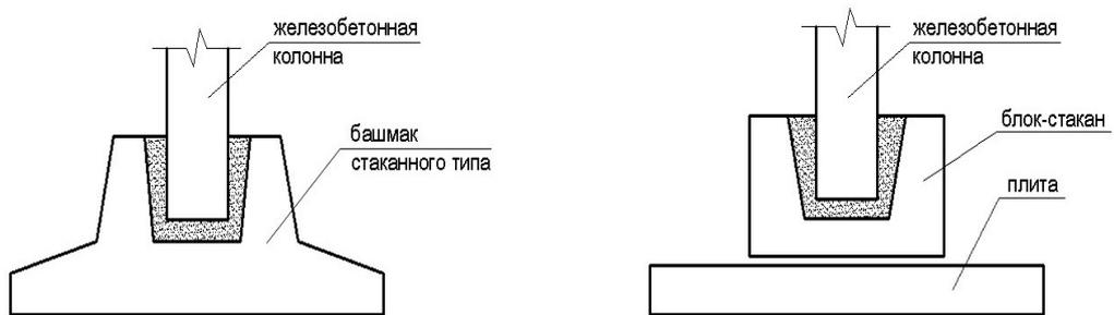
Рис.4.13. Столбчатые фундаменты под железобетонную колонну:
