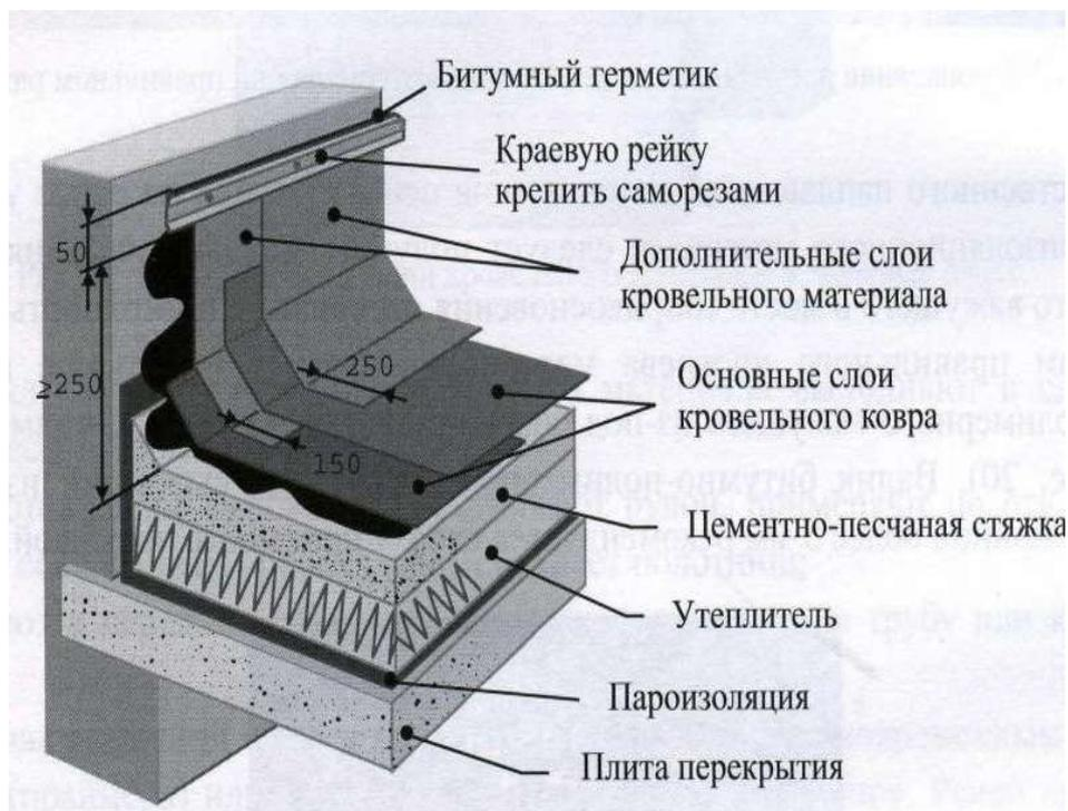
Рис.8.57. Примыкание кровельной системы к вертикальной поверхности.
