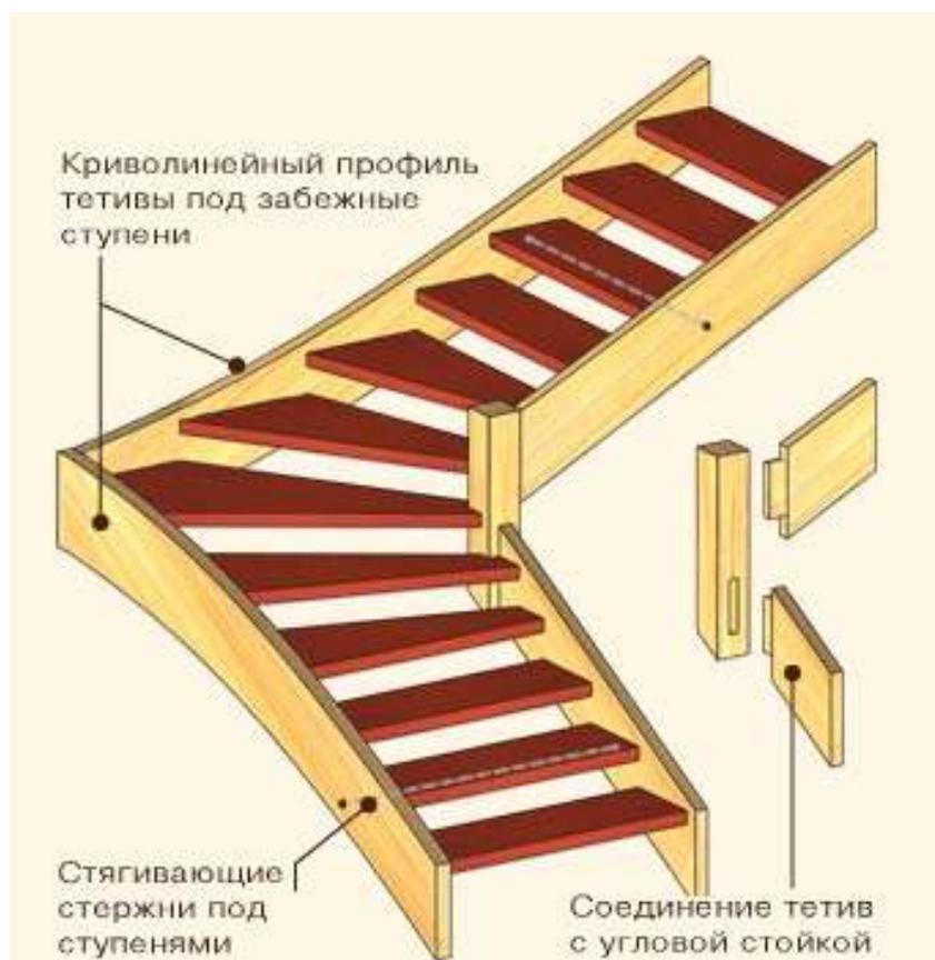
Рис.7.23. Конструкция деревянной лестницы с забежными ступенями.
