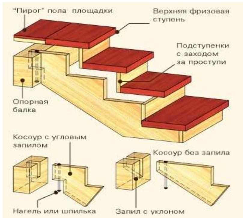
Рис.7.25. Деревянная лестница с косоуром и врезкой на несущую балку.
