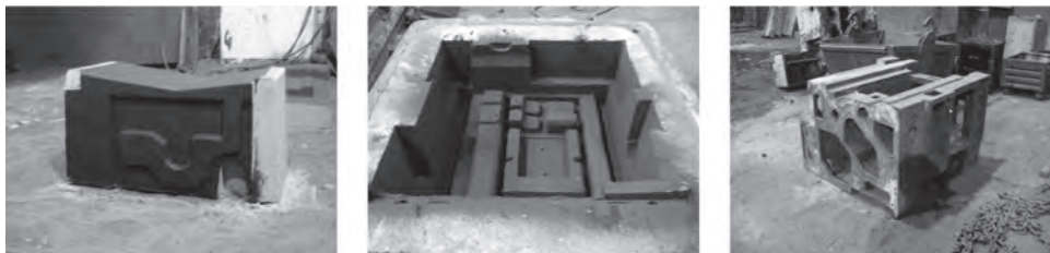
Рис. 3. Пример использования противопопригарных покрытий при производстве отливок станин в условиях РУП «Вистан»
