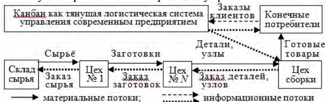
Рис. 1. Схема тянущей логистической системы производства
