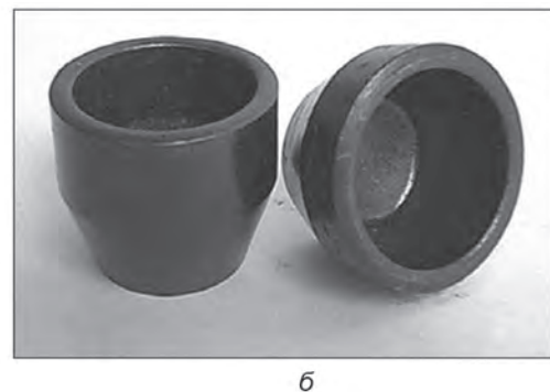
Рис. 14. Получение изделий из чугуна типа втулок горячим выдавливанием: а – инструмент для получения детали «направляющая втулка клапана», исходная заготовка, втулка с трещинами, качественная втулка; б – деталь «корпус сверлильного патрона» из чугуна, полученная выдавливанием за один проход из цельной цилиндрической заготовки
