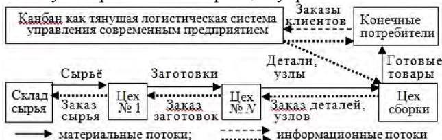
Рис. 1. Схема тянущей логистической системы производства
