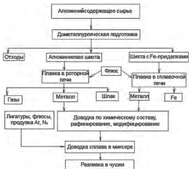
Рис. 5. Технологическая схема-алгоритм процесса рециклинга алюминия и его сплавов
