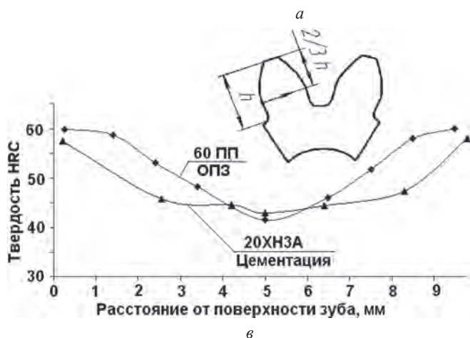
Рис. 18. Распределение твердости по различным сечениям конической прямозубой зубчатой поверхности: а – по вершине зуба; б – по впадине зуба; в – по боковой поверхности на расстоянии 2/3 от вершины
