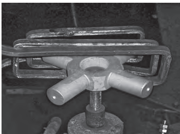
Рис. 10. Сквозной индукционный нагрев крестовина межколесного дифференциала ведущего моста из стали 60ПП в асимметричном электромагнитном поле
