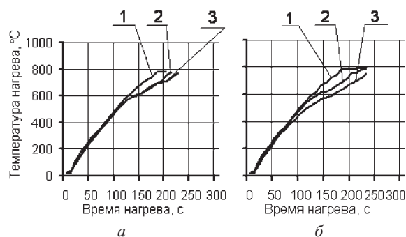
Рис. 9. Изменение температуры нагрева по трем точкам измерения для шестерен колесной передачи заднего моста: 1 – впадина зуба; 2 – тело зуба; 3 – внутренняя поверхность; a – сателлит; б – шестерня
