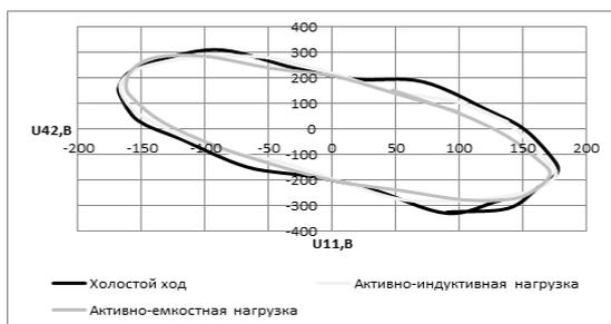
Рисунок 4 – Фигуры Лиссажу при различных нагрузках
