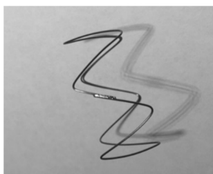
Рисунок 1 – Зигзагообразный элемент стентграфта из нитинола
