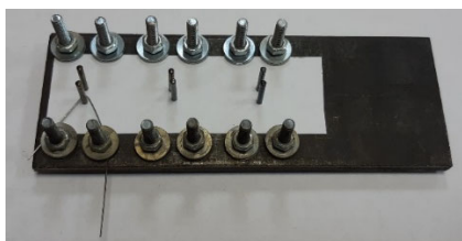
Рисунок 3 – Экспериментальный вариант приспособления для придания проволоки зигзагообразной формы
