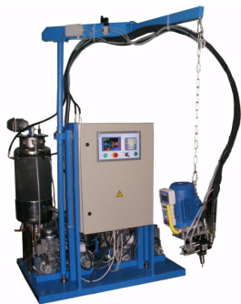
Рисунок 2 – Заливочно-смесительная установка низкого давления
