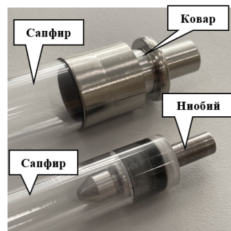
Рисунок 1 – Фото цилиндрических спаев сапфира с ниобием и коваром
