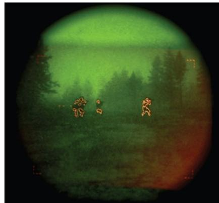
Рисунок 2 – Пример комбинированного изображения с оконтуриванием
