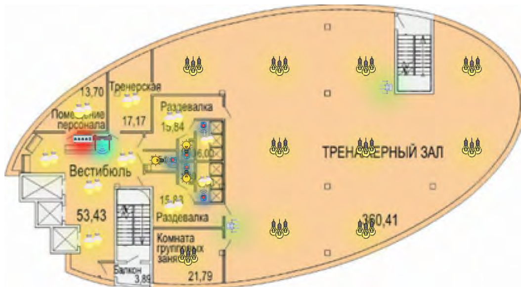
Рисунок 6 – Вариант расстановки элементов системы «HomeMODE» для фитнес-клуба (Примечание: разработка авторов на основе [5]).
