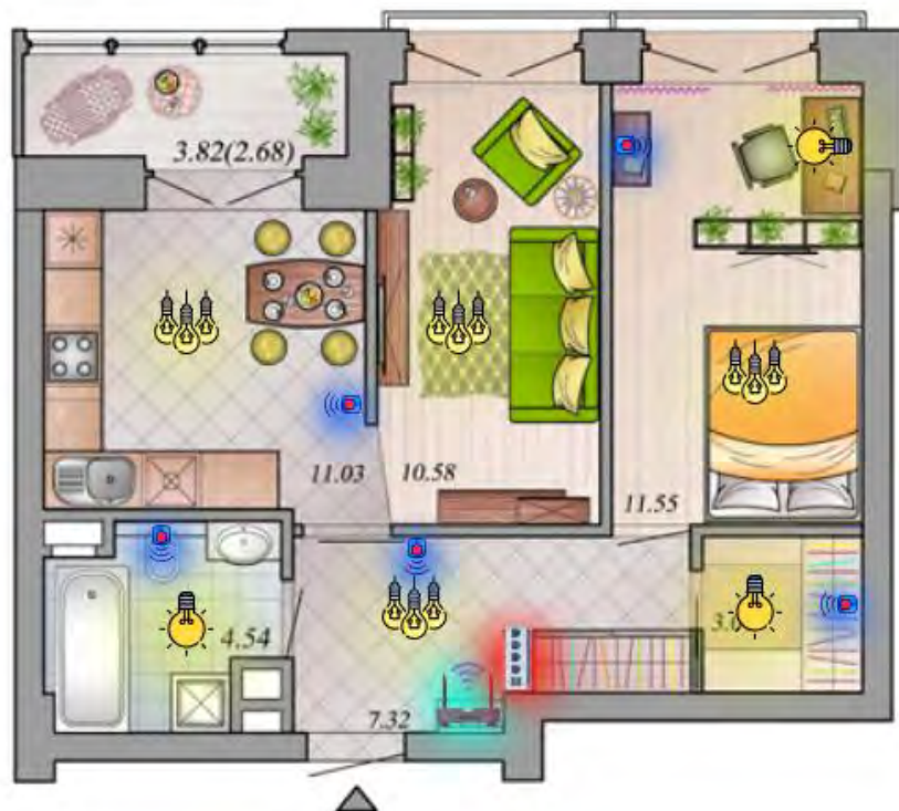
Рисунок 1 – Вариант расстановки элементов системы «HomeMODE» для однокомнатной квартиры (Примечание: разработка авторов на основе [5]).
