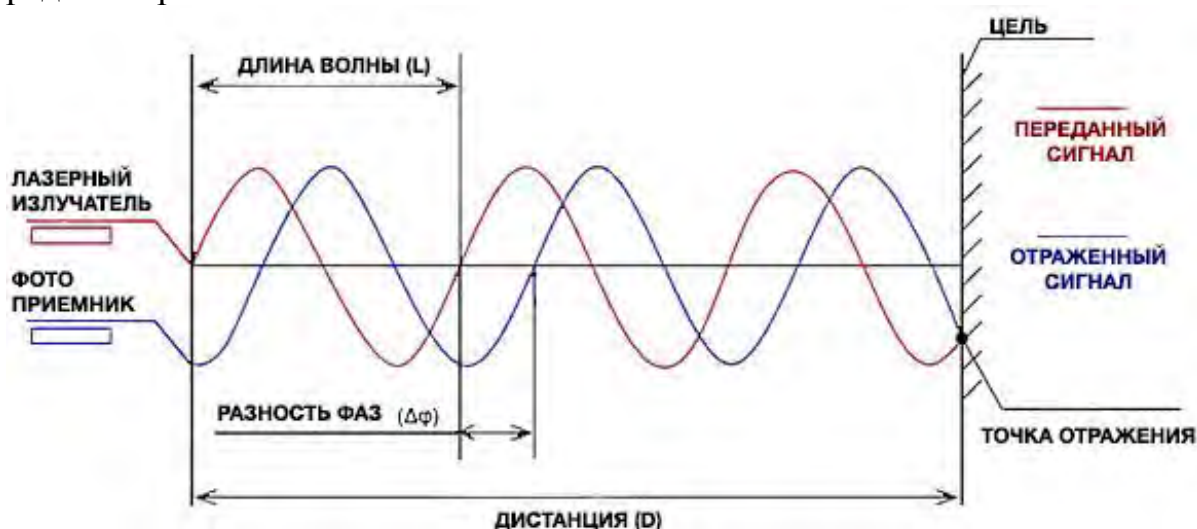
Рисунок 1. Фазовый метод измерения расстояний
