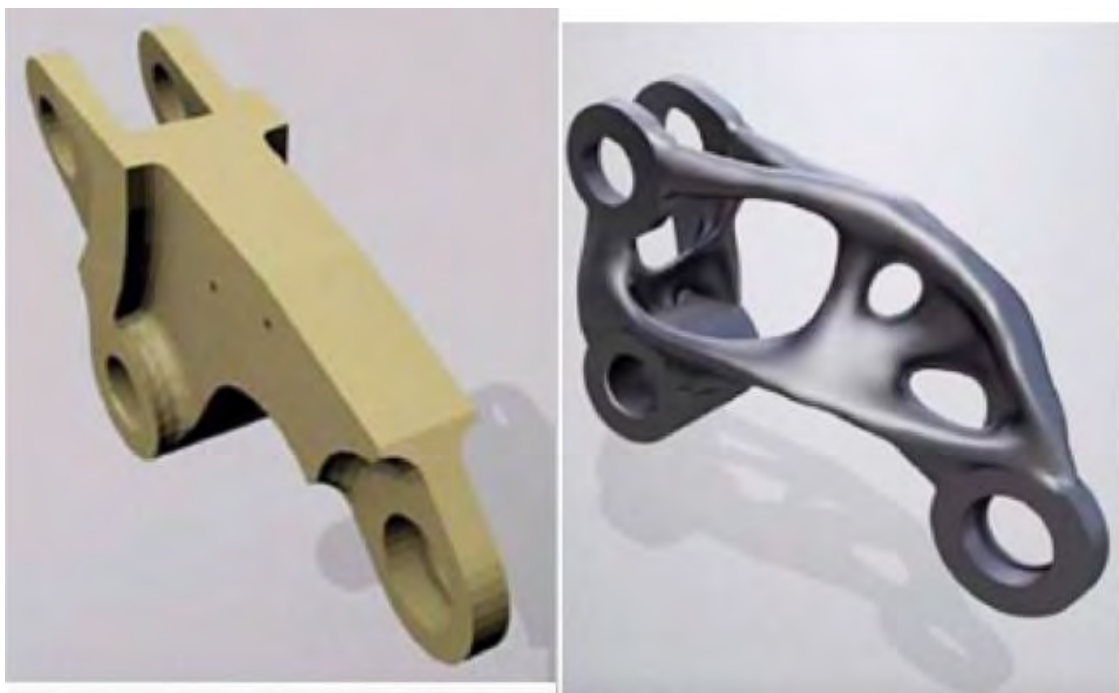
Рис. 2. Топологическая оптимизация детали
