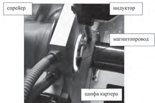
Рис. 6. Нагрев галтели картера цапфы на установке фирмы «Termamacchina»
