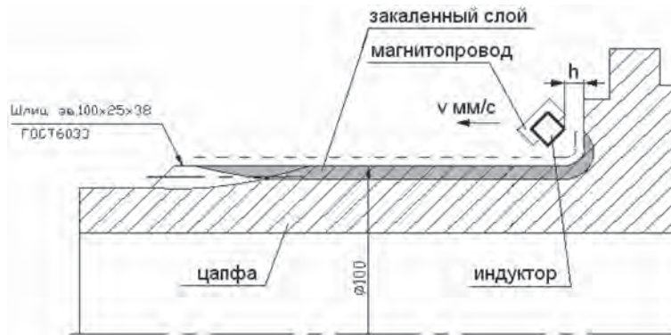
Рис. 7. Схема закалки цапфы картера заднего моста непрерывно-последовательным способом при движении индуктора относительно детали
