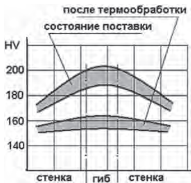
Рис. 20. Распределение твердости на трубе до и после индукционной термообработки
