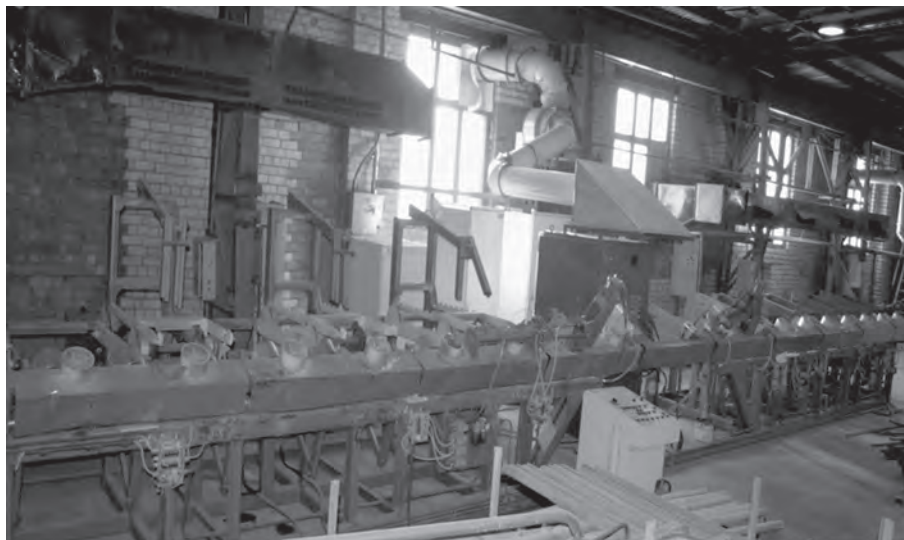
Рис. 22. Общий вид линии термообработки стальных прямоугольных труб
