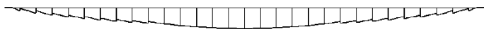
Рисунок 8. Эпюра изгибающих моментов в нижнем слое составной балки при нагрузке по всему пролету и отсутствии связей сдвига в центральной части
