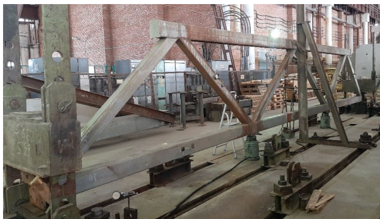
Рисунок 3. Общий вид подстропильной фермы марки ПФБ-24-54 пролетом 12 м при испытании статическим нагружением
