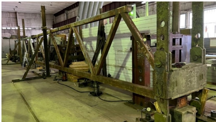
Рисунок 2. Общий вид стропильной фермы марки ФСБ-24-2,4 пролетом 24 м при испытании статическим нагружением
