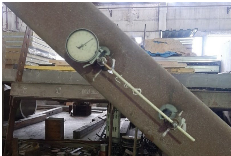
Рисунок 4. Контроль напряжений в элементах ферм с помощью многооборотных индикаторов МИГ с ценой деления 0,001 мм на базе 200 мм
