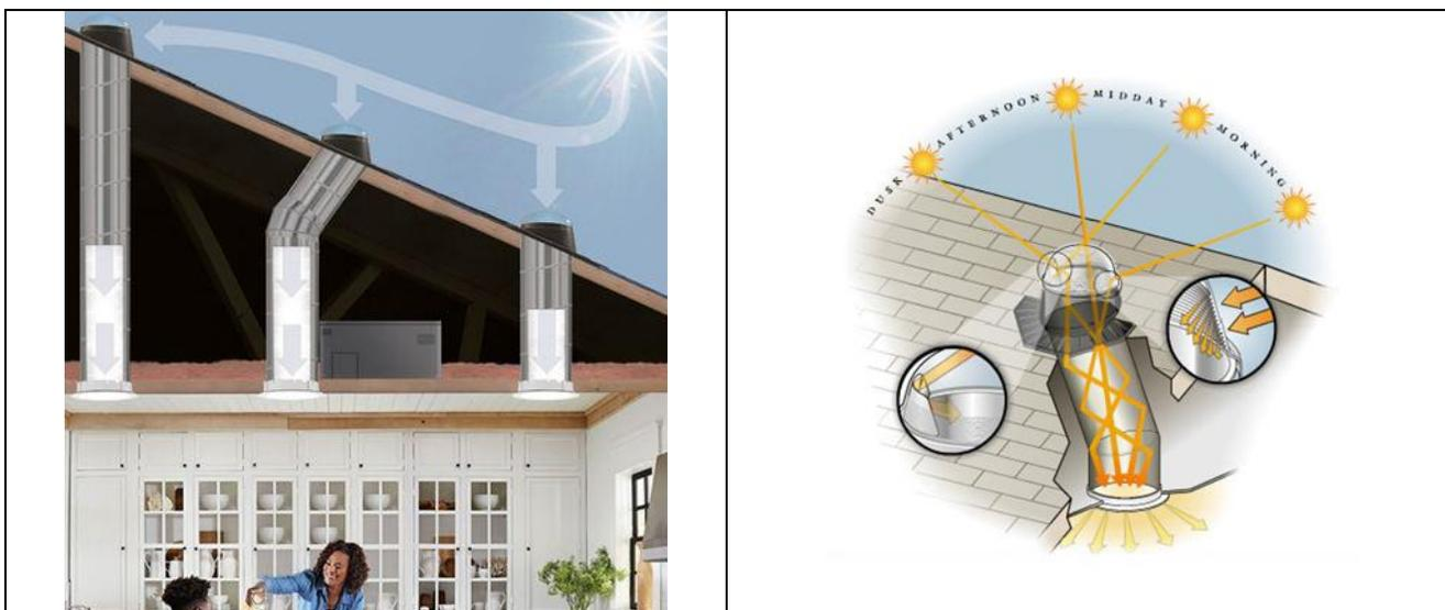
Рисунок 1. Принцип работы световода
