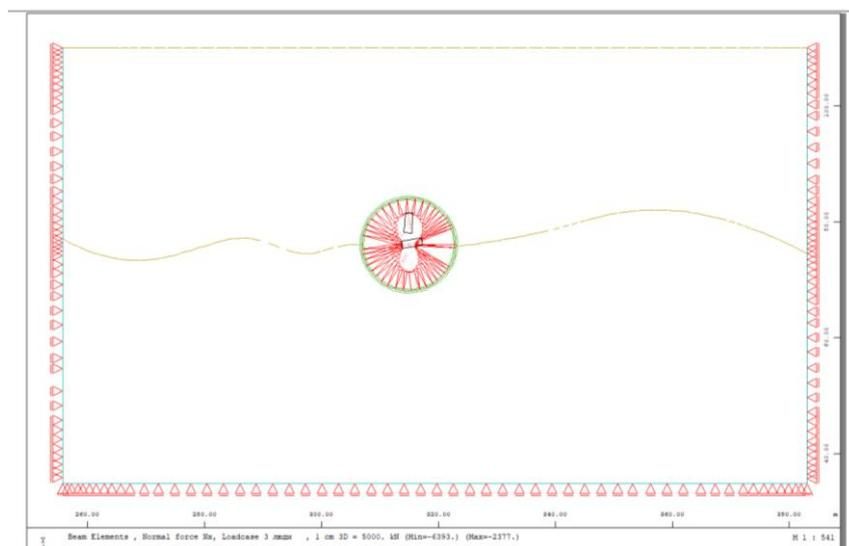
Рисунок 11 – Эпюра продольных усилий, возникающая в конструкции железобетонной обделки на стадии завершеного строительства тоннеля
