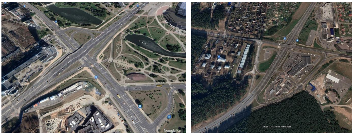
Рисунок 1 – Пример планировочных решений неполных транспортных развязок (Республика Беларусь, г. Минск, Минский район)
