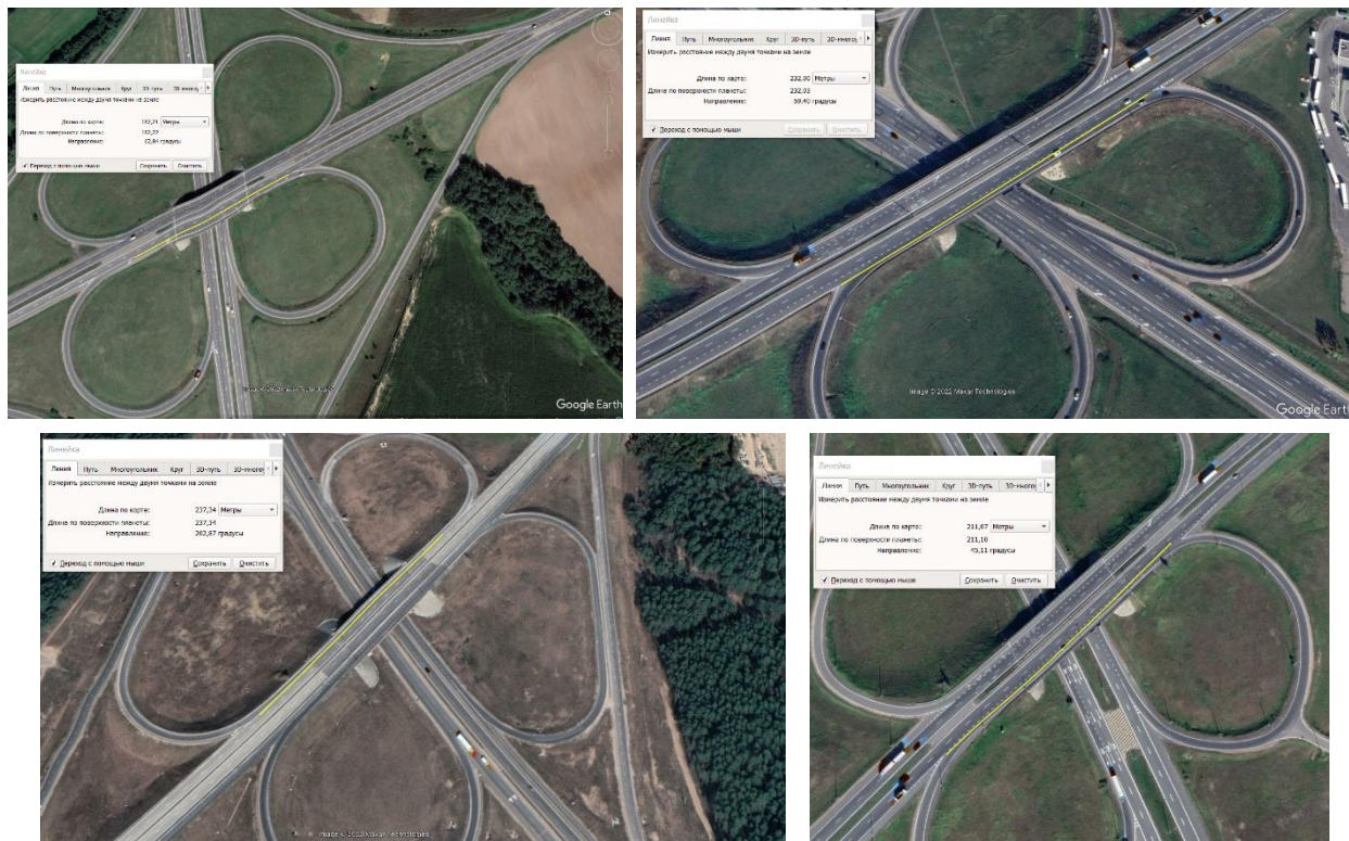
Рисунок 1 – Зона переплетения транспортных потоков
