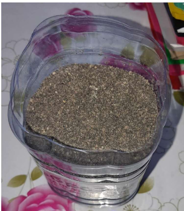
Рисунок 2 – Внешний вид асфальтобетона после ресайклинга
