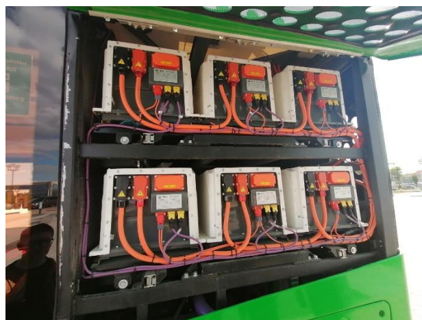
Рисунок 2 – Компоновка аккумуляторных модулей в электробусе
