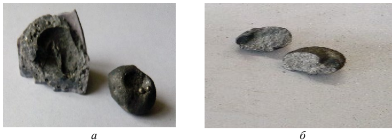
Рисунок 2 – Результаты повторного переплава продуктов восстановительной плавки (а) и образец борсодержащей лигатуры (б)
