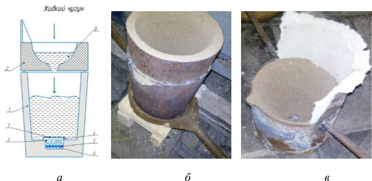
Рисунок 1 – Схема (а), общий вид ковша (б) и переходной крышки (в) для сфероидизирующего модифицирования ЧШГ (Tandish cover): 1 – ковш; 2 – переходная крышка; 3 – реакционная камера с лигатурой; 4 – стальная высечка; 5 – перегородка; 6 – графитизирующий модификатор; 7 – слой дисперсного карбюризатора; 8 – жидкий чугун;
