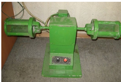
Рисунок 4 – Прибор для определения осыпаемости песчаных стержней
