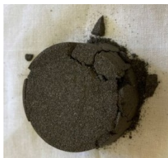
Рисунок 2 – Брикет после испытаний его на раздавливание
