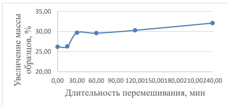
Рисунок 2 – Влияние длительности перемешивания на кроющую способность силит-20
