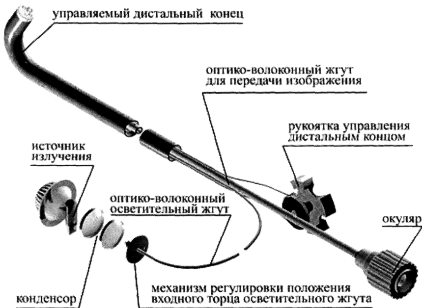
Рис. 6.25. Оптико-механическая схема эндоскопа
