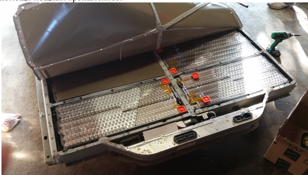
Рисунок 4 – Вскрытие аккумуляторной батареи
