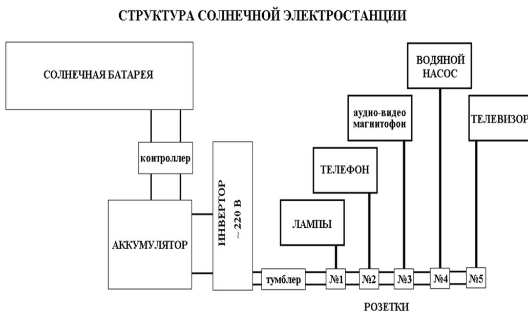
Рис. 1 Блок схема структуры разработанной солнечной электростанции
