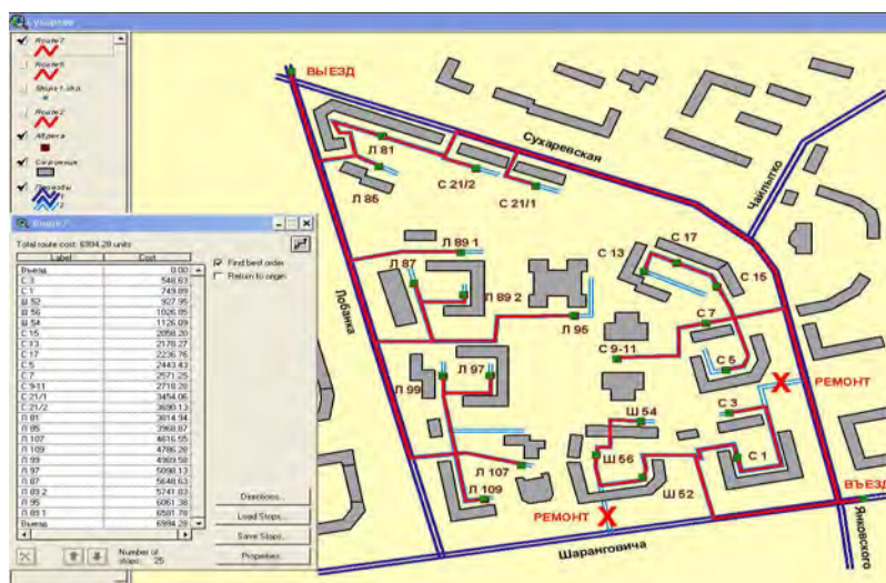
Рис. 3. Результат моделирования оптимального маршрута при сборе ТБО (некоторые внутренние проезды закрыты для движения автотранспорта)
