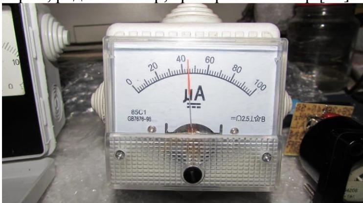
Рисунок 18 - Индикатор на китайской головке прозрачный пластик 60x55мм.
