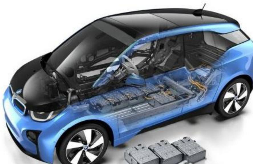
Рисунок 2.- Размещение электрооборудования в электромобиле.
