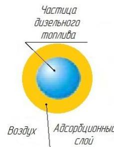
Рисунок 7 – Образование адсорбционного слоя на частице дизельного топлива
