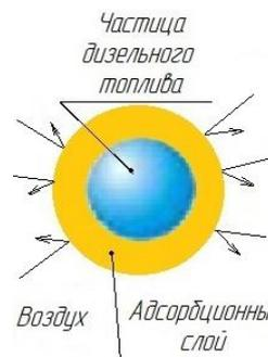
Рисунок 8 – Недостаток кислорода для возгорания дизельного топлива
