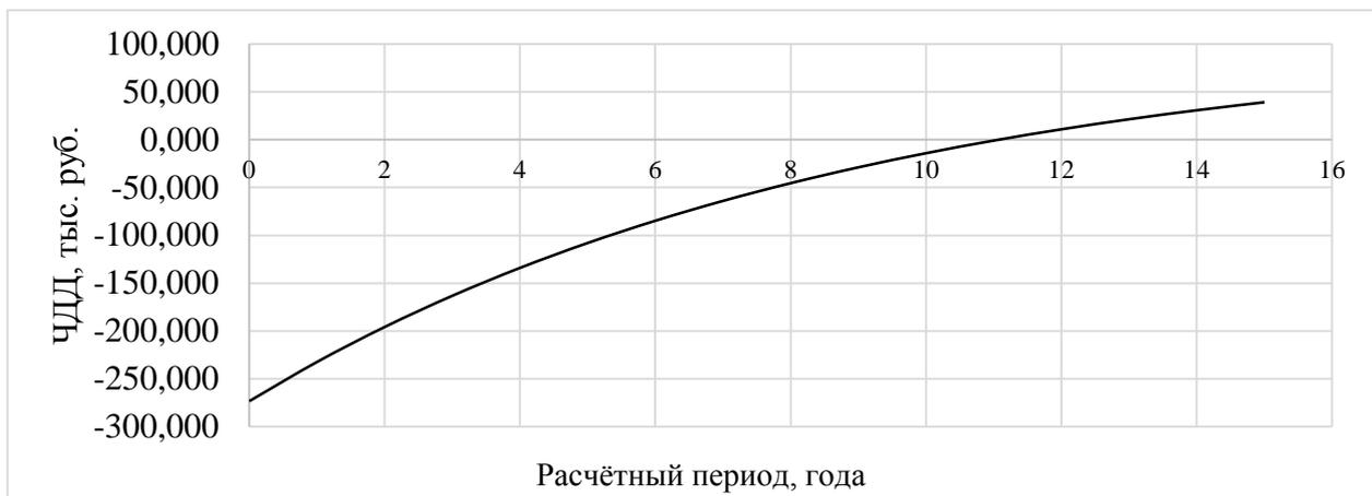
Рисунок 4 – Зависимость ЧДД от шага расчетного периода.
