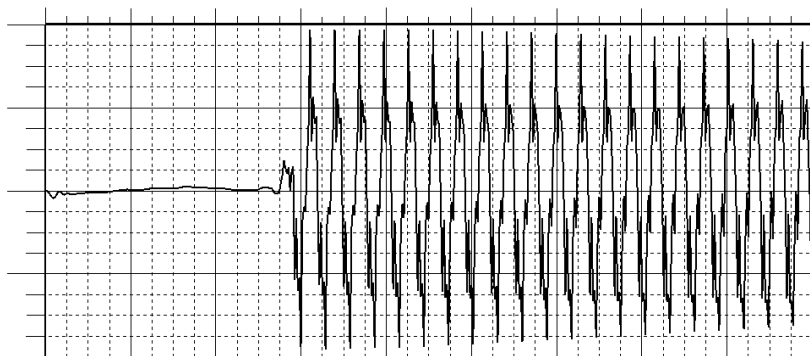
Рисунок 8. Изменение во времени ускорения центральной массы при скорости поезда 40 м/сек
