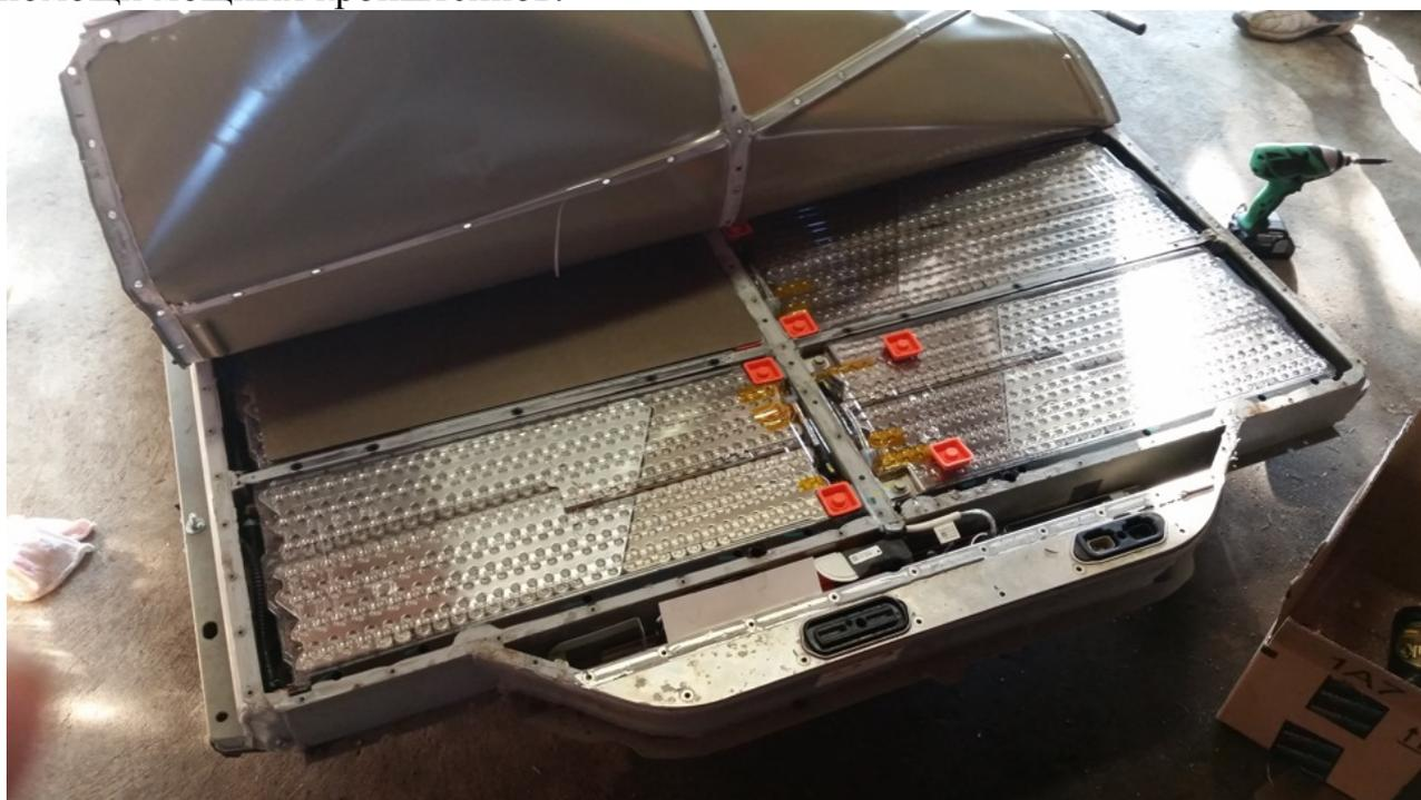
Рисунок 4 – Вскрытие аккумуляторной батареи
