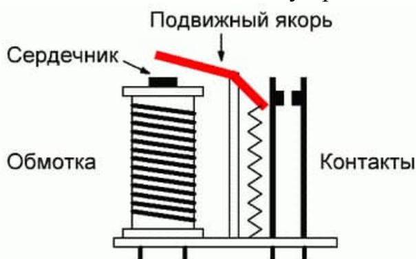
Рисунок 5 – Устройство механического реле
