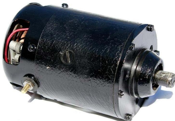
Рисунок 3 – Генератор автомобиля Форд модель Т
