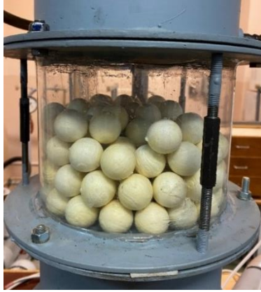
Рис. 2. Насадка в абсорбционной колонне
