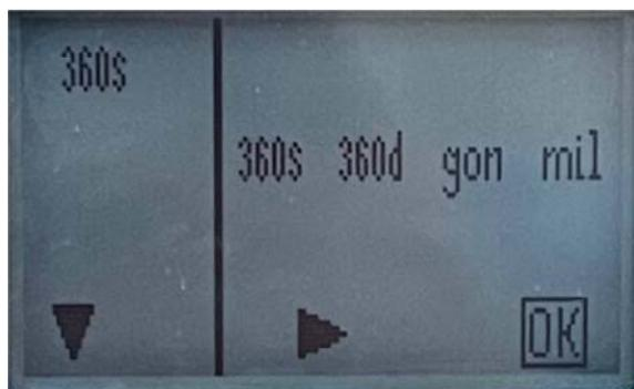
Рис. 3.5. Настройка единиц измерения угла
