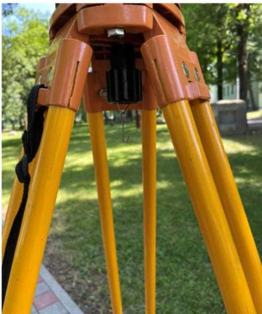
Рис. 1.3. Становой винт треноги
