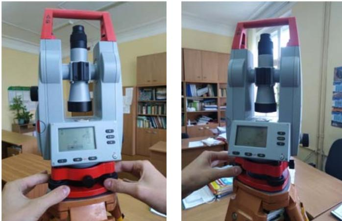
Рис. 1.9. Выставление прибора в нуль-пункт
