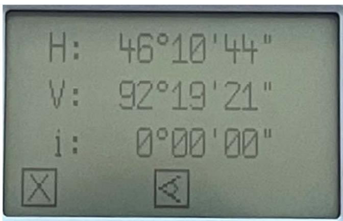
Рис. 2.10. Определение места нуля (МО) вертикального круга теодолита
