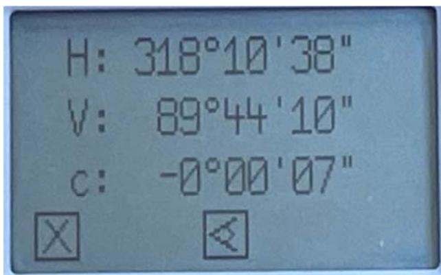
Рис. 2.6. Определение коллимационной ошибки
