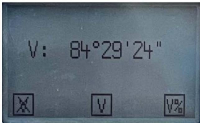
Рис. 3.3. Настройка отображения вертикального угла на дисплее
