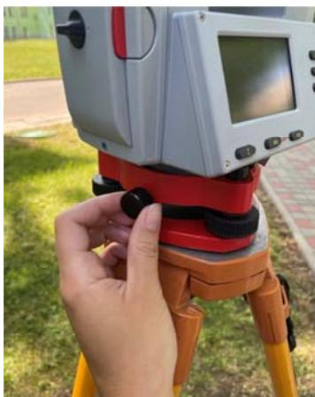
Рис. 1.7. Регулировка винта трегера
