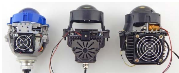
Рис. 7. Серийные модули фар ближнего света на основе светодиодов с принудительным охлаждением (слева направо): Lumisfera – Wide, i-Lens, Lumisfera – Far [4]
