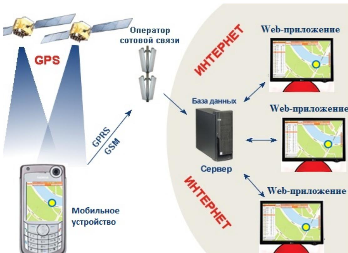
Рисунок 1. Общая схема функционирования разрабатываемой системы позиционирования и контроля
