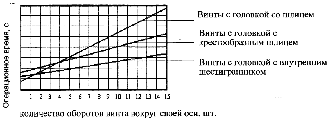
Рис. 3. Влияние конструкции головки винта на операционное время при использовании метода ручной сборки
