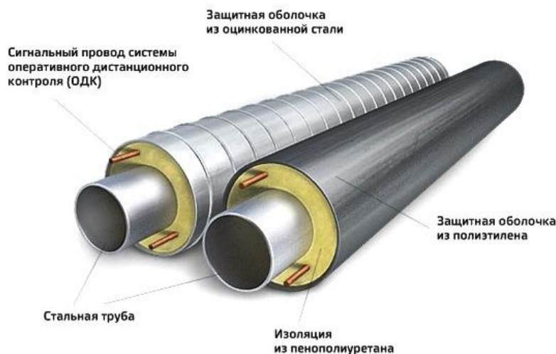
Рисунок 4.7 – Схема устройства труб ППУ с полиэтиленовой и оцинкованной оболочкой
