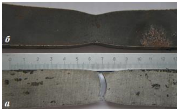
Рис.5.9 - Вид первого (б, 20 мм) и второго (а, 8мм) образцов после испытания
