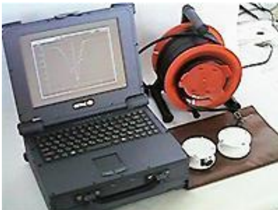
Рисунок 3.1 - Вид основных компонент мобильного измерительного комплекса для проверки мостов
