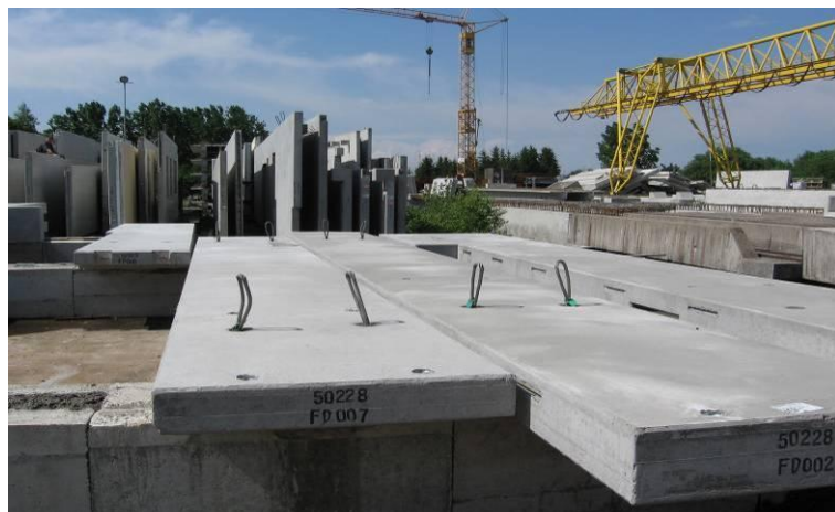
Рисунок 1. Панели перекрытия с упрощённым профилем
