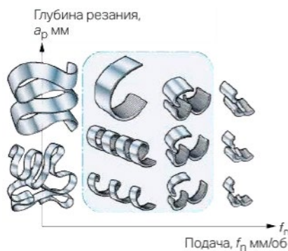
Рис. 1 – Диаграмма «глубина резания – подача»
