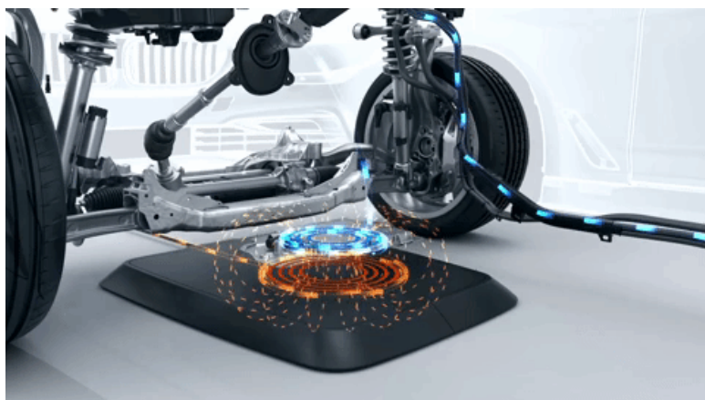
Рис. 1 – Схема работы беспроводной зарядки
