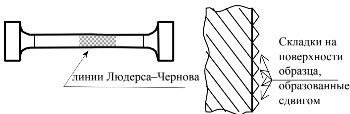
Рис. 8. Образование линий Людерса–Чернова
