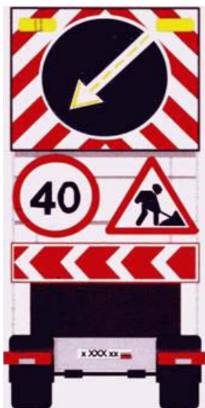
Рис. 4.6. Автомобиль сопровождения с мобильным табло изменяющейся дорожной информации
