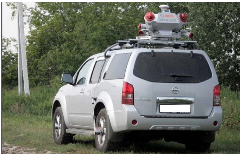
Рис. 3.4. Мобильный лазерный сканер (МЛС), установленный на автомобиль
